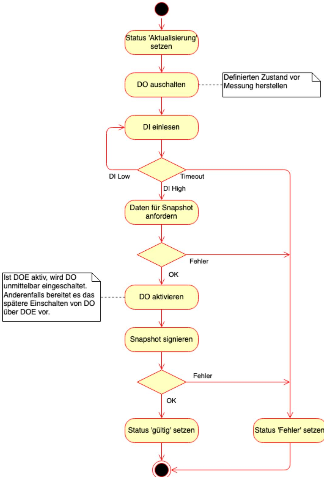
Prinzip Ausschaltvorgang: Das Register 41033 wird auf 2 gesetzt. Der nachfolgende Ablauf wird dann automatisch durch die Firmware gesteuert.
