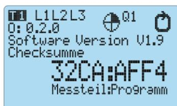
Die Versionsnummer sowie die Checksumme der Software werden im Display dargestellt und können über die beiden Schnittstellen ausgelesen werden.
