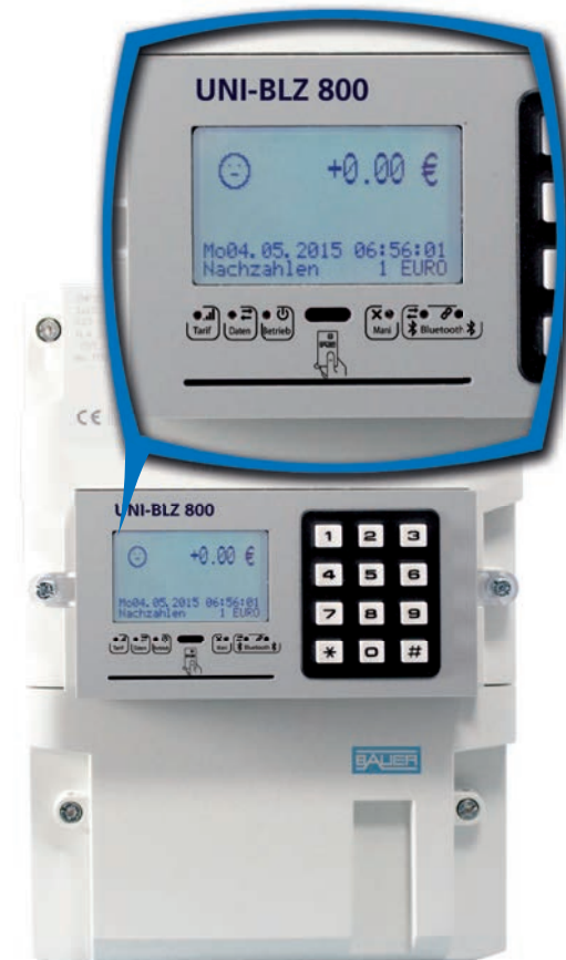
hinterleuchtetes Grafikdisplay alle Anzeigen im Klartext
